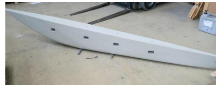
Järnköl med öppningar på sidorna
