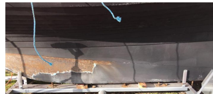
Järnköl med öppningar undertill, anledningen till slipningen var att jag letade efter öppningar på sidorna
