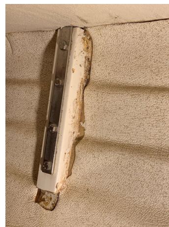
Gamla röstjärnsinfästningen som lätt sågas bort med finesåg
