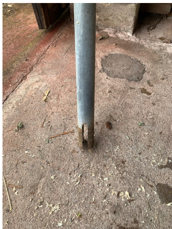
Hylsnyckel av ett rör med uppsågad slits
